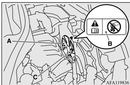
A- Вентилятор охлаждения
